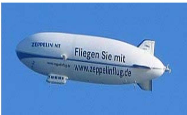
Рис. 4. Современный полужесткий дирижабль «Zeppelin NT», Германия
